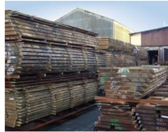
aussi deux types de séchage du bois, comme le séchage des palanquées à l'air libre qui met 1 an à sécher, et le séchage des palanquées au gaz qui met, lui, 1 semaine. Après le séchage les palettes de
