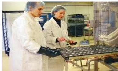
A la sortie du four, on vérifie la température puis les cannelés sont mis dans un tunnel de surgélation puis mis en boîte.
