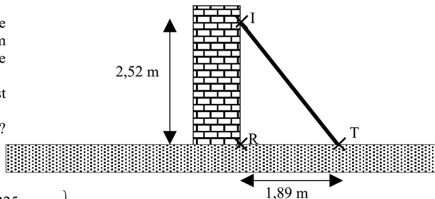
$$\left. \begin{array}{l} TI^2 = 3,15^2 = 9,9225 \\ IR^2 + RT^2 = 2,52^2 + 1,89^2 = 9,9225 \end{array} \right\} TI^2 = IR^2 + RT^2 \text{ D'où, d'après la réciproque du théorème de Pythagore, le triangle TRI est rectangle en R et par conséquent, le mur est vertical.}$$
